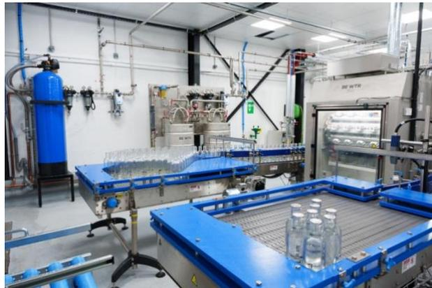
L'usine d'embouteillage BE WTR, située dans le 18<sup>e</sup> arrondissement de Paris, produit jusqu'à 1 500 bouteilles en verre capsulées d'eau plate et gazeuse fraîche par heure. Les bouteilles sont ensuite livrées et récupérées aux clients de la zone de chalandise locale. Chaque bouteille peut être lavée et réutilisée plusieurs centaines de fois, ce qui garantit un impact minimal sur l'environnement.
